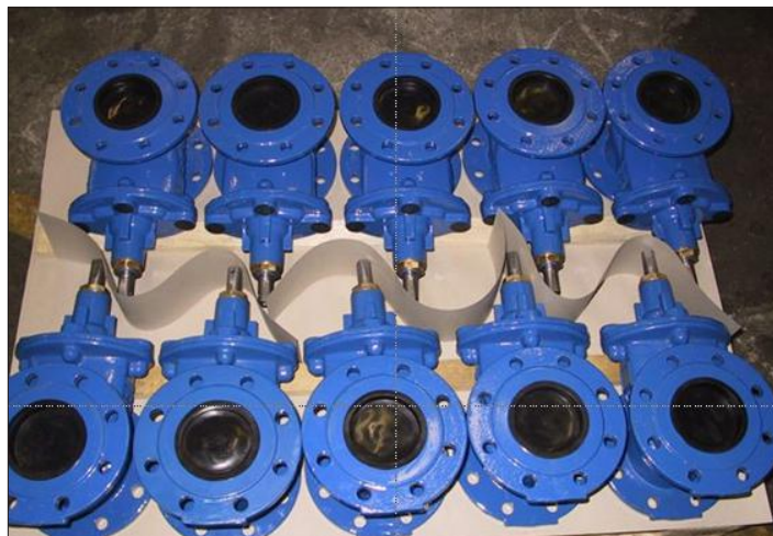
Рис. 1: Положение при транспортировке задвижек VAG EKO®plus
